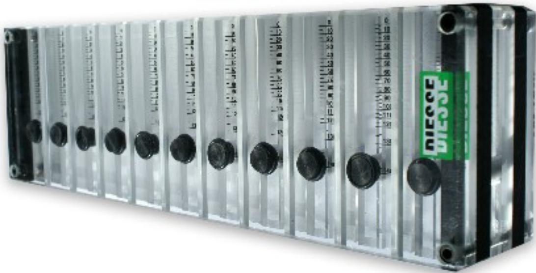
Systeme manuel pour la détermination de la vitesse de sédimentation (VS) de 20 échantillons simultanément, en utilisant des cuvettes DIESSE (VacuTec - VacuCode - VesTec)
