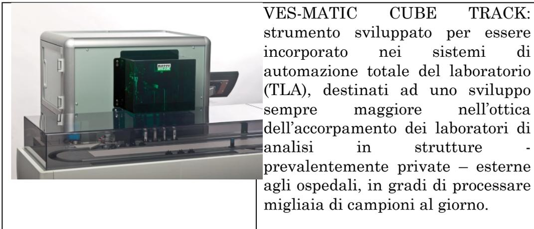
I principali vantaggi della Linea VES-MATIC riguardano la sicurezza per gli operatori in quanto il sistema è completamente chiuso, l'utilizzo della provetta di prelievo come dispositivo di lettura, il minimo volume di sangue con l'utilizzo delle provette VACU-TEC e VES-TEC, l'utilizzo di provette in plastica anziché in vetro, l'agitazione, lettura e stampa dei risultati in completa automazione.
