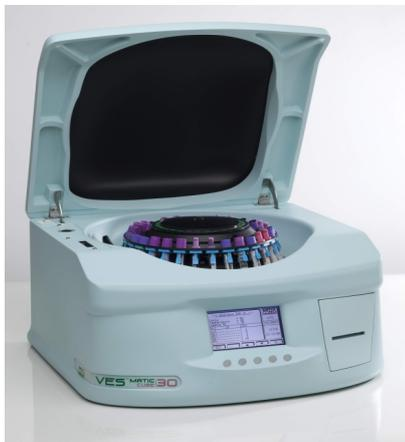
VES-MATIC CUBE 30: strumento mutuato dal VES-MATIC 30, consente di eseguire la VES direttamente nelle provette da emocromo su 30 campioni contemporaneamente. Pensato sia come strumento di *back-up* degli strumenti più grandi, sia per laboratori di medie dimensioni, consente di eseguire approssimativamente 60 esami VES all’ora. Anche in questo caso la selezione dei “campioni VES” è automatica
