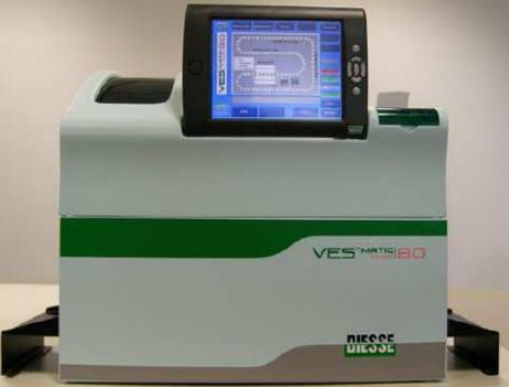
A larger, light green and white laboratory instrument with a screen on top displaying a graph. The label 'VES-MATIC 80' and 'DIESS' are visible on the front.                                | <p>VES-MATIC CUBE 80: utilizza, per il caricamento in continuo dei campioni, i rack dedicati forniti con lo strumento. La produttività massima è di 95 VES/ora. Anche in questo caso lo strumento permette la selezione dei campioni su cui effettuare l'esame della VES.</p>
